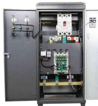
**Оф-лайн (Р)** — Исполнение с шунтирующим контактором. После окончания разгона, силовые ключи УПП шунтируются внешним контактором. В этом исполнении, по окончании разгона, УПП потребляет минимум электроэнергии и выделяет минимум тепла. Отвод тепла может потребоваться только в момент пуска электродвигателя. Занимает большую площадь в шкафу.
